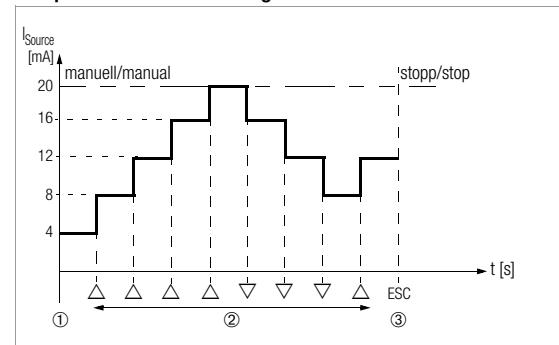
Die Zeitabstände sind abhängig vom Bediener (nur im Automatikbetrieb gleich).
