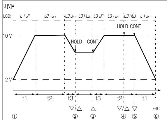
**Rampenparameter:** Ausgabegröße: U (Bereich 0 ... 15 V),  $Start = 2$  V,  $End = 10$  V,  $t_1 = 5$  s,  $t_2 = 8$  s,  $t_3 = 5$  s,  $t_{PEPEL}$  für periodische Rampe
